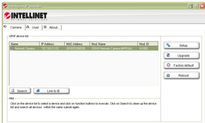
Cuando el programa arranca, se presenta la pantalla arriba mostrada. La utilería IP Installer lista todas las cámaras que se encuentren conectadas a su red. Con esta utilería podrá realizar cambios a la configuración, actualizar el firmware, reestablecer los valores de fábrica y reiniciar la cámara. Nota: Podrá tomar hasta tres minutos el mostrar la cámara que ha sido recientemente reiniciada.
