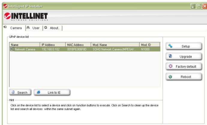
All'avvio del programma, compare la videata sopra riportata. L'utilità IP Installer elenca tutte le telecamere che possono essere rilevate nella rete. Con questa utilità è possibile effettuare dei cambiamenti alla configurazione, eseguire un aggiornamento del firmware, ripristinare i valori di fabbrica predefiniti e riavviare la telecamera. **Nota:** Potrebbero essere necessari fino a tre minuti perché l'IP Installer mostri una telecamera che è stata recentemente (ri-) avviata.
